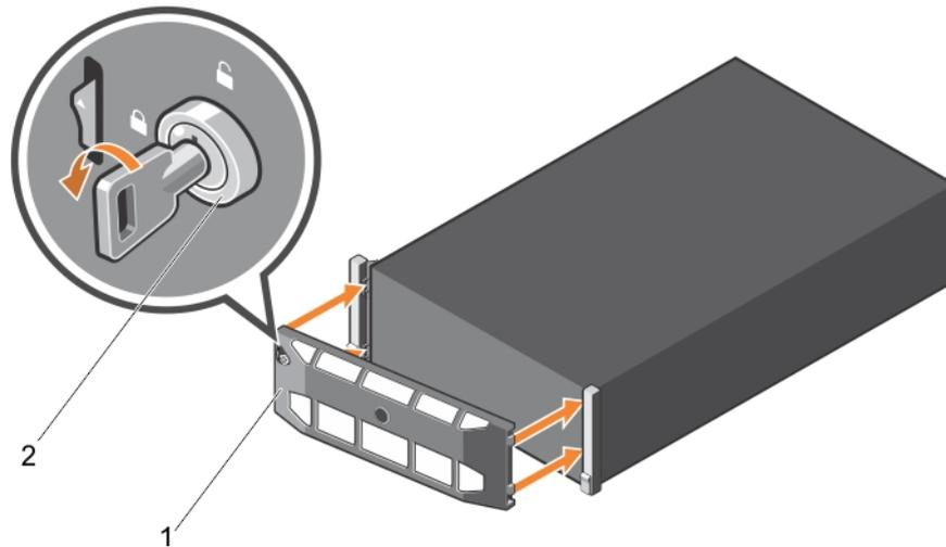
**Figure 12. Installing the optional front bezel**
