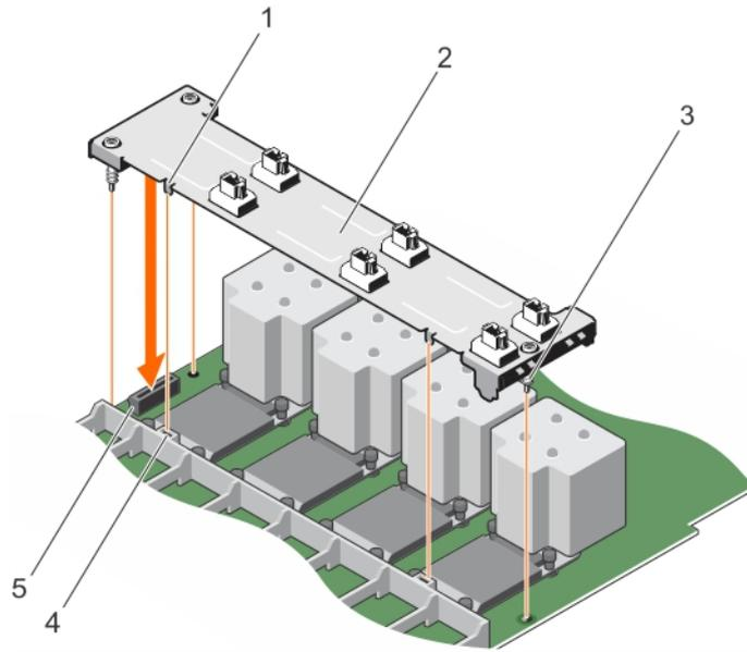
**Figure 30. Installing the fan tray**
