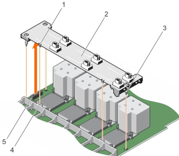
**Figure 29. Removing the fan tray**
